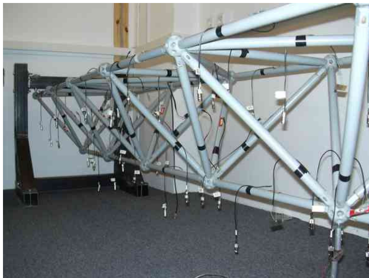
Rys. 7 Kratownica 3-wymiarowa do testów laboratoryjnych
