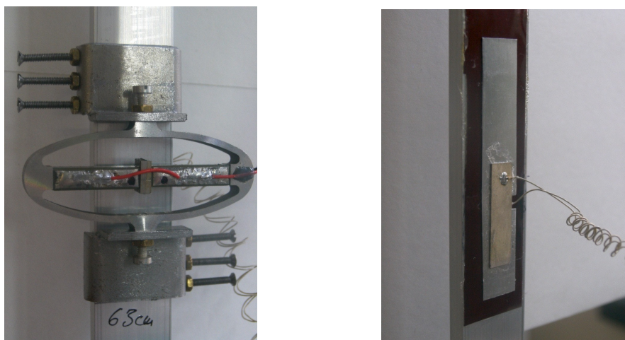
Rys. 3 Aktywator (a) i sensor (b) piezoelektryczny, zamontowane na belce wspornikowej
